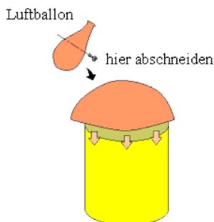
Fig. 1 Mit einer Gummi Membran eine Blechdose verschließen
