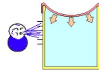
Fig.3 Bei Kühlung sinkt der Luftdruck
