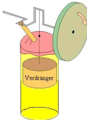
Fig. 10 komplette Maschine mit Kurbelwelle und Schwungrad
