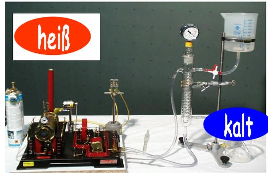
Abb. 10: Modelldampfmaschine mit Kondensator [14]
