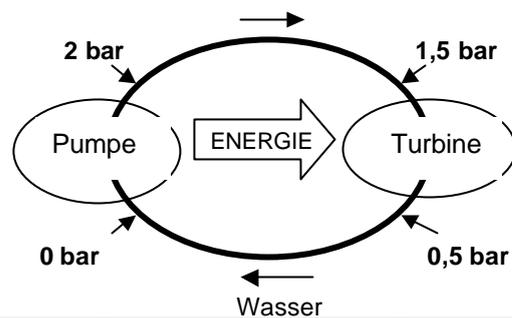
Es strömt Energie von der Pumpe zur Turbine. Das Wasser ist der Energieträger. Die Pumpe belädt das Wasser mit Energie. Die Turbine lädt Energie vom Wasser ab. Die **Druckdifferenz  $D_p$**  gibt an, wie viel Energie in einem Umlader auf bzw. vom Wasser abgeladen wird. Der **Energiestrom** der in einem Umlader von einem Wasserstrom abgeladen bzw. von einem Wasserstrom aufgeladen wird ist umso größer,...
