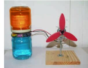
Abb. 17: Eine Temperaturdifferenz  $\Delta T$  treibt ein Thermokraftwerk an!
