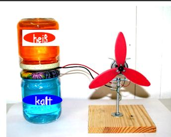
Abb. 18: So wie das Wasser vom Behälter mit dem hohen Druck in den Behälter mit tiefem Druck strömt, so strömt die Entropie vom Glas hoher Temperatur zum Glas mit tiefer Temperatur.
