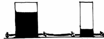
Abb. 6: Die Druckdifferenz als Antrieb eines Wasserstroms
