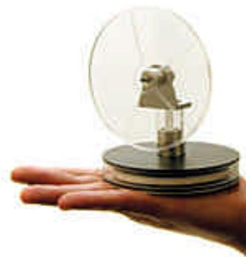
Abb. 12: Die warme Hand scheint zum Antrieb des Stirlingmotors [16] zu genügen. Durch das Kühlen der oberen Platte mit Eis, läuft der Motor schneller und kräftiger.
