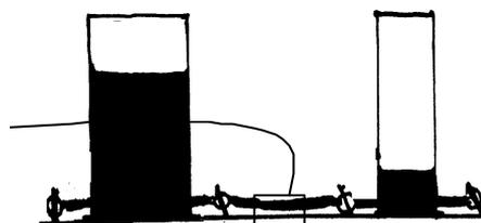
Abb. 21: Durch das Anschließen einer Batterie, wird das Thermoelement zu einer „Wärmepumpe“. Analog entsteht eine Druckdifferenz, wenn mithilfe einer Pumpe Wasser gepumpt wird.
