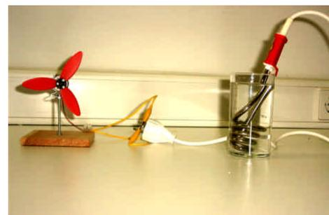
Abb. 27: Der „Tauchgefrierer“ kühlt das Wasser ab, und treibt mit der dem Wasser entzogenen Energie den Lüfter an.
