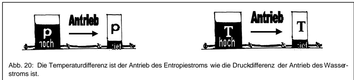
Abb. 20: Die Temperaturdifferenz ist der Antrieb des Entropiestroms wie die Druckdifferenz der Antrieb des Wasserstroms ist.
