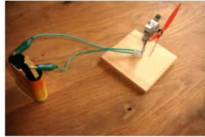
Abb. 16: Eine elektrische Potenzialdifferenz  $\Delta \phi$  treibt einen Elektromotor an!
