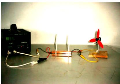
Abb. 23: Energie fließt vom Netzgerät zur „Wärmepumpe“, zum „Thermokraftwerk“, zum sich drehenden Lüfter.
