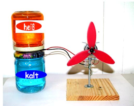
Abb. 11: Thermokraftwerk mit Thermoelement [15]
