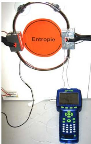
Abb. 6: Temperaturmessung vor und nach dem Peltierelement
