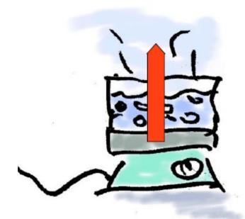
Wenn man kochendes Wasser weiter kochen lässt, wird es nicht wärmer. Es geht keine Wärme ins flüssige Wasser. Stattdessen wird Dampf erzeugt. Der Dampf enthält mehr Wärme als das flüssige Wasser.
