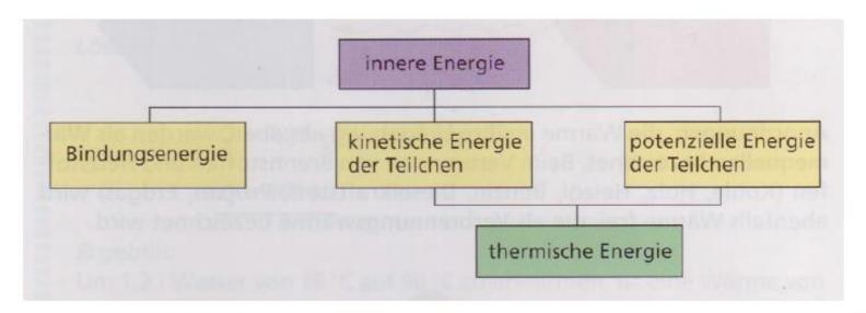
Die **thermische Energie** ist Teil der inneren Energie und wird weitgehend ? durch die Temperatur bestimmt. Da man in vielen Fällen von der Konstanz der anderen Bestandteile ausgehen kann, wird mitunter nur die thermische Energie betrachtet.?
