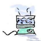
Wenn man kochendes Wasser weiter kochen lässt, wird es nicht wärmer. Es geht keine innere Energie ins flüssige Wasser. Stattdessen wird Dampf erzeugt. Der Dampf enthält mehr innere Energie als das flüssige Wasser.
