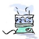
Wenn man kochendes Wasser weiter kochen lässt, wird es nicht wärmer. Es geht keine Wärme ins flüseige Wasser. Stattdessen wird Dampf erzeugt. Der Dampf enthält mehr Wärme als das flüssige Wasser.
