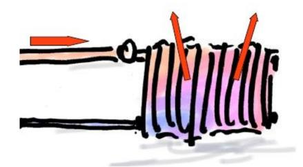
Das Wasser transportiert Wärme vom Heizkessel zu den Heizkörpern.
