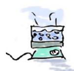
Wenn man kochendes Wasser weiter kochen lässt, wird es nicht wärmer. Es geht keine Wärme ins flüssige Wasser. Stattdessen wird Dampf erzeugt. Der Dampf enthält mehr Wärme als das flüssige Wasser.
