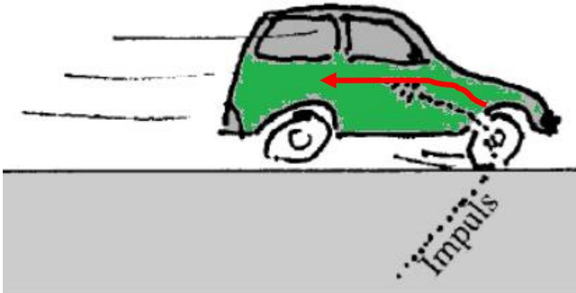
Beim beschleunigenden Auto kommt der Impuls aus der Erde und die Energie vom Motor bzw. aus dem Treibstoff.
