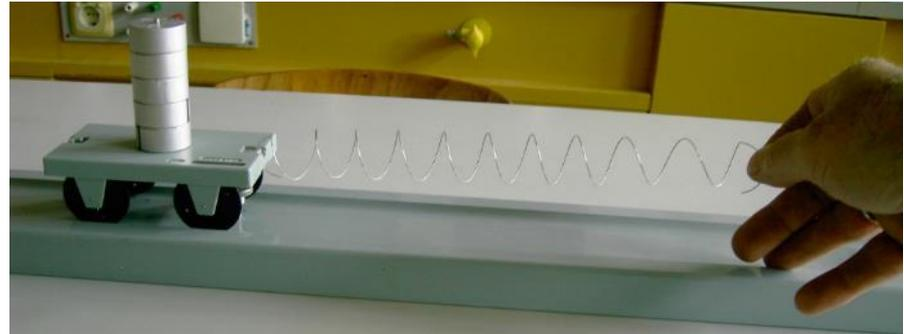
Die Verlängerung der Feder ist ein Maß für die Stärke des durchfließenden Impulsstromes in Zugbelastung.
