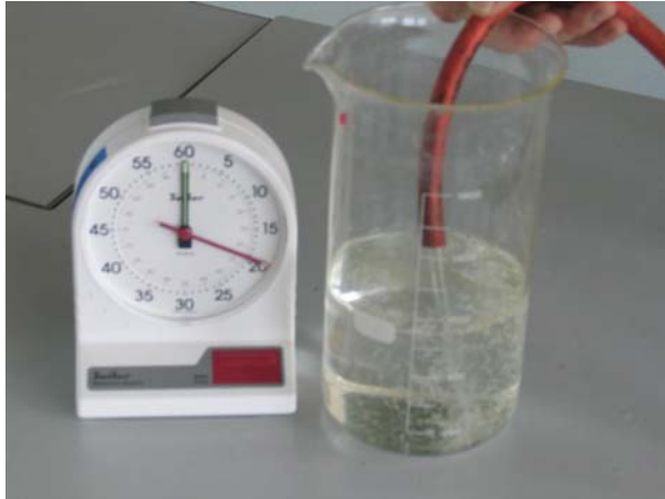
Abb. 9: Messung der Wasserstromstärke
