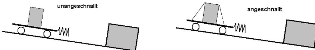
Der Wagen wird während der Zeit  $t_1$ , in der sich die Knautschzone zusammendrückt, abgebremst. Aber der Fahrer bewegt sich weiter bis er das Armaturenbrett erreicht und seinen Impuls in kurzer Zeit  $t_0$  abgibt.
